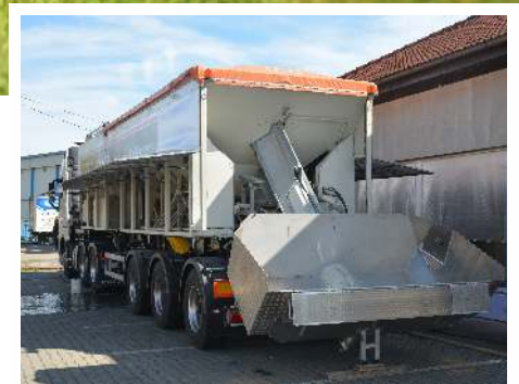
Systém pro nakládku kameniva za provozu stroje bez speciálních dopravních prostředků
