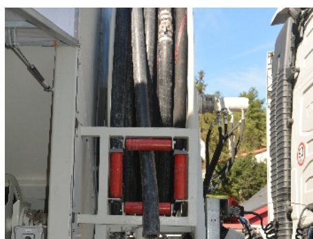
Dobře přístupné hadice na materiál o délce až 200 metrů
