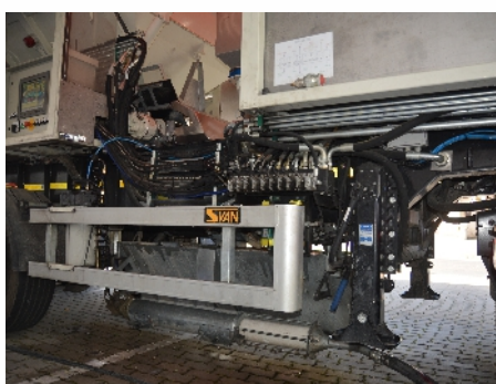
Hydraulické ventily DANFOSS jsou řízené digitálně pomocí průmyslové sběrnice CAN
