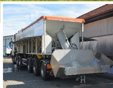
Systém pro nakládku kameniva za provozu stroje bez speciálních dopravních prostředků
