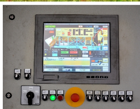
Řídicí systém s přehlednou dotykovou obrazovkou s propojením na tablet s dispečerským programem
