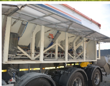
Zvedací bočnice chrání obsluhu před deštěm a vytváří úložný prostor pro příslušenství
